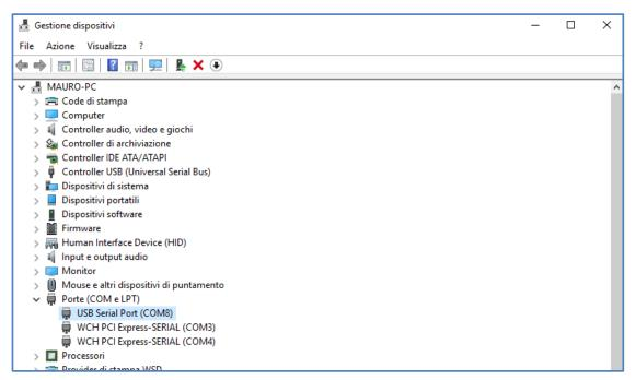
6. Avviare il programma DLOADX e selezionare la porta COM utilizzata dall'USB-RS (► CONNESSIONE ► CONFIGURAZIONE ► Porta RS-232)
